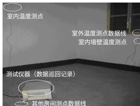
图 1 测试仪器及测点布置
