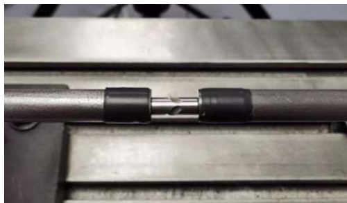
图 3 Hopkinson 压杆高速冲击试验装置
