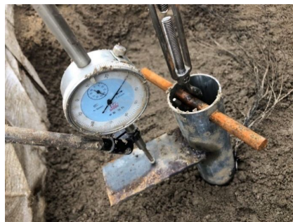
图 3 抗拔桩靴预埋图
