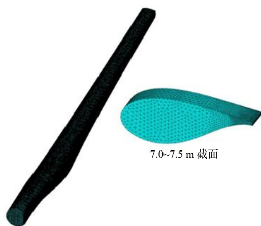
图 5 叶片结构拓扑优化有限元模型
