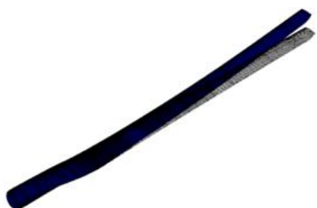
(b) 传统结构优化方案一阶振型
