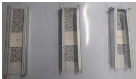
图16 落锤冲击试件的残余变形
