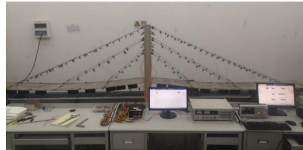
图 3 斜拉桥振动试验检测平台实物图
