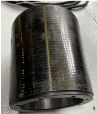
图2 碳纤维绑扎的电机转子
