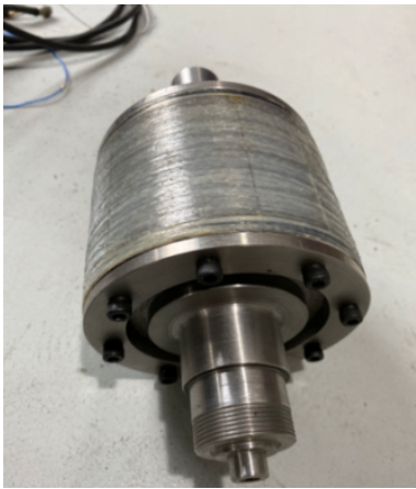
图1 玻璃纤维无纬带绑扎的电机转子
