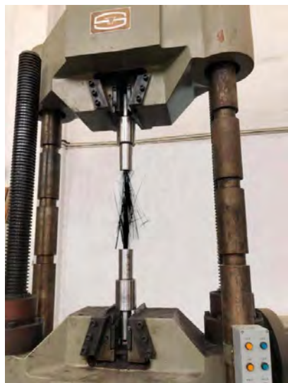
图 3 CFRP 筋张拉力试验
