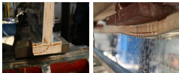
图6 L-6 加载点处钢材屈曲及 LVL 板斜向开裂破坏
