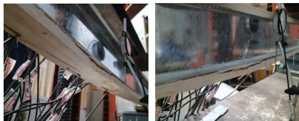
图7 L-7 组合梁跨中下翼缘脱胶破坏
