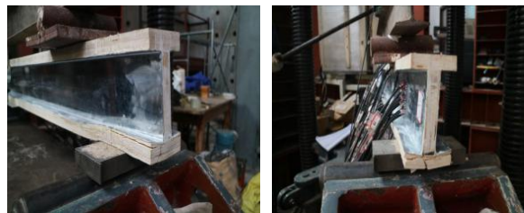
图5 L-2 支座处下翼缘板开裂和钢材屈曲
