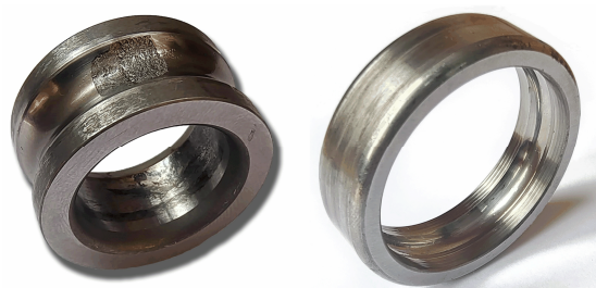
图8 滚动轴承内外圈疲劳剥落
