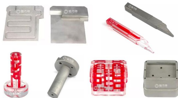
图 19 铂力特增材技术股份有限公司制造的模具镶块 [87]
