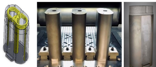
(a) 随形流道设计 (b) 减材制造所得底座 (c) 嫁接打印所得样件
