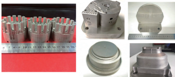
图 18 华中科技大学增材制造的模具镶块 [85]
