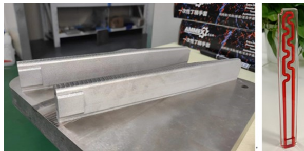
图 21 北京航空航天大学宁波创新研究院增材制造中心制造的模具冷却镶块
