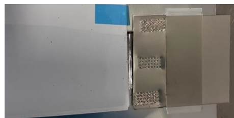
图3 双层极耳连接碳基集流体
