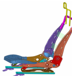
图 2 座椅骨架有限元模型
