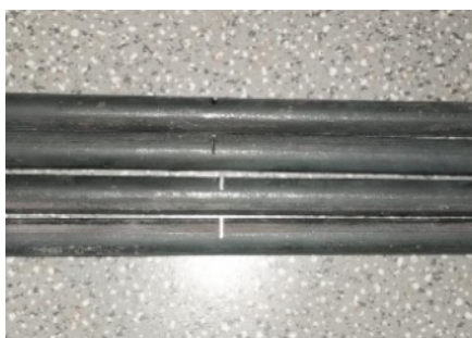
图3 钢筋机械损伤加工
