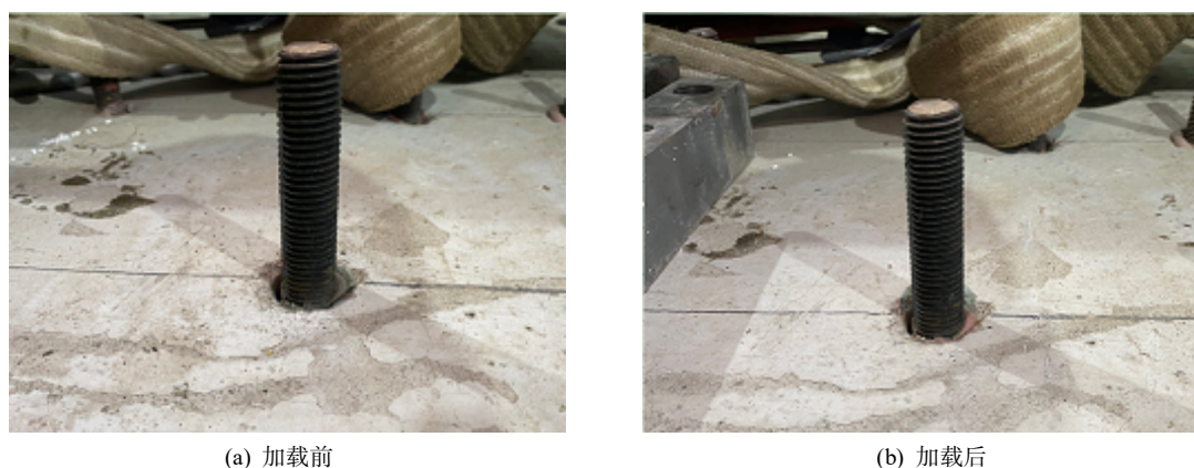
图4 弹性段内加载前后植筋对比
