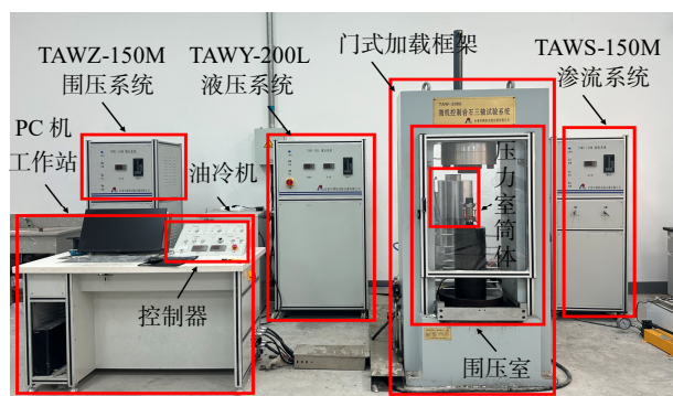
(a) TAW-2000 微机控制岩石三轴试验系统
