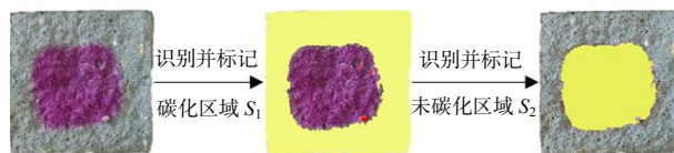
图2 ImageJ软件识别试件碳化面积过程
