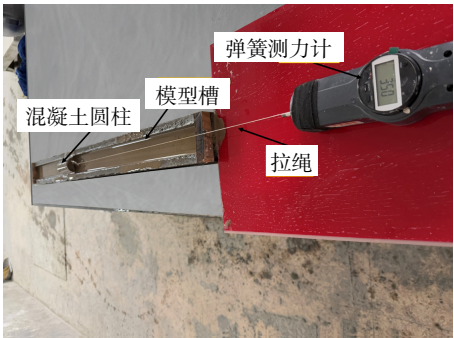
(a) 顶管模型及模型槽
