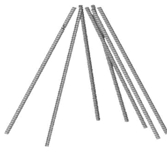
图 3 独立防撞墩的有限元模型
