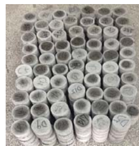
图 2 打磨后的试样
