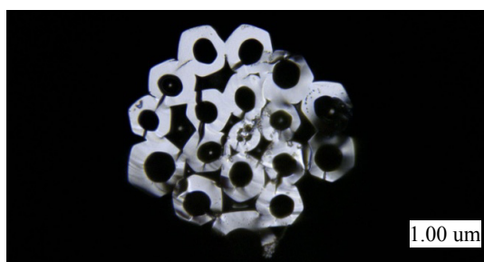
图 8 光学显微镜下 3 层孔 \text{As}_2\text{S}_3 PCF 光纤端面
