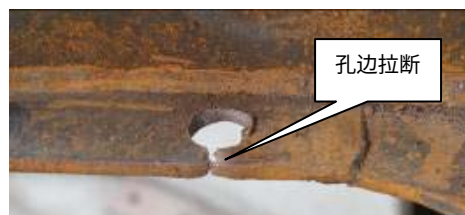
图 8 JD2 试件的破坏照片
