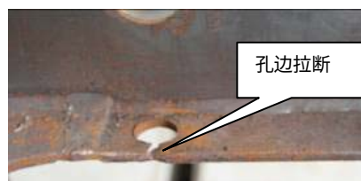
图 6 JD1 试件的破坏照片
