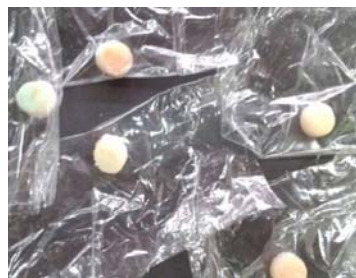
图 2 保鲜膜密封的猪皮试样
