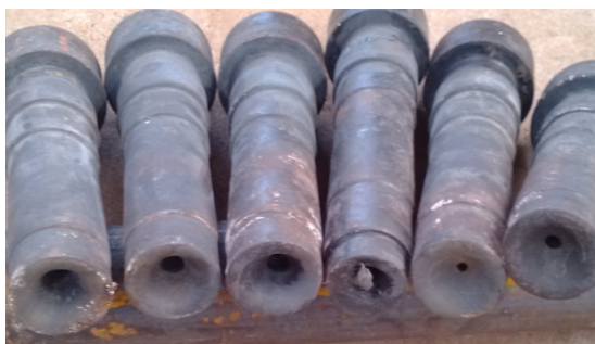
图 1 楔横轧生产中产生的凹心
