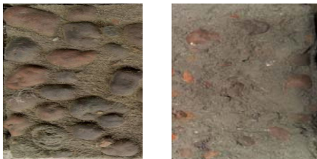
图 1 露骨料剂(左)和凿毛法(右)处理界面对比
