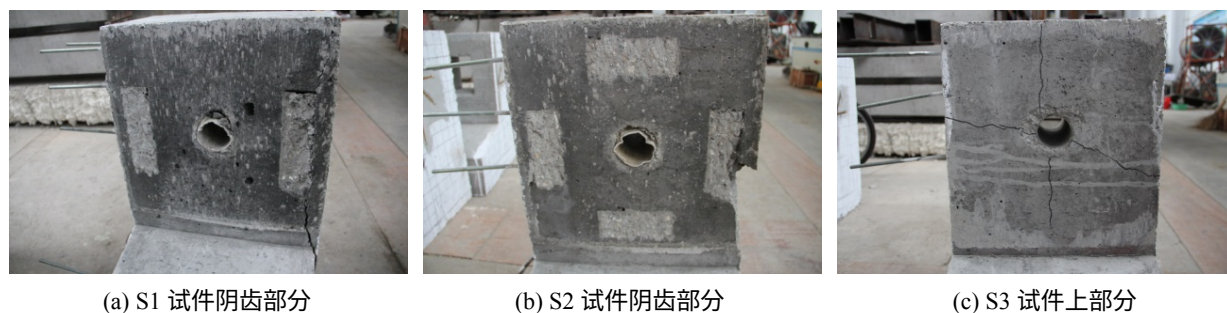
图7 试件破坏情况
