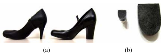
图4 实验用鞋侧面(a)及后跟支撑面积(b)示意图 [71]
