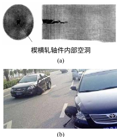
图1 轴件内部缺陷及车轴断裂事故
