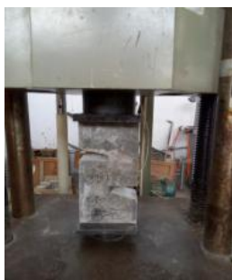
图1 Z形抗剪试件(单位:mm) 图2 试验加载装置
