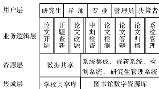
图3 基于网络的学位论文过程管理与质量监控平台的软件架构
