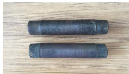
图 10 闭开联合轧制实验冷却后的轧件
