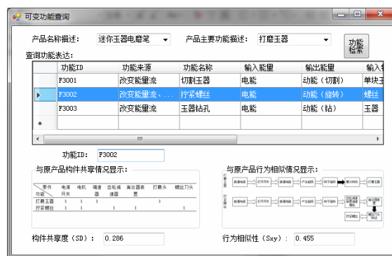
图10 拧紧螺丝和打磨玉器功能参数查询
