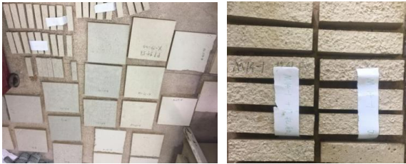
图 1 成型的纤维改性硫氧镁水泥基仿木保温材料试件
