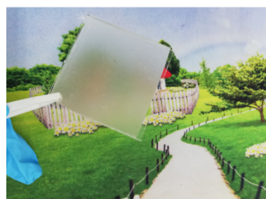
(b) 制备的玻璃基底镀 OMO 并贴敷 PDMS 的样品距图案 5 cm 的视觉效果
