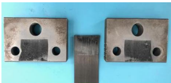
图 10 CFRP板滑移破坏状态
