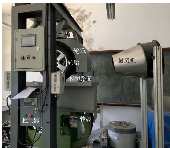
图2 车轮路面模拟试验装置
