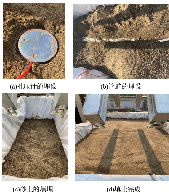
图 6 填土过程及仪器的埋设
