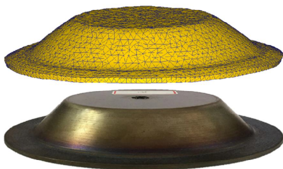
图6 旋压成形仿真模拟件和实验件
