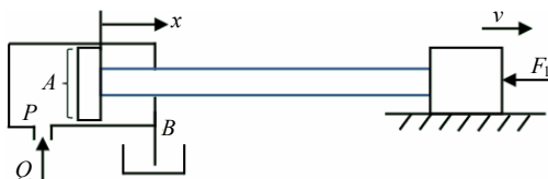
图5 液压缸工作原理
